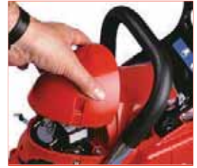
Alet gerektirmeden filtre bakımı yapılabilir
