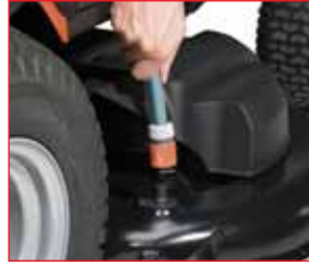
Kolay temizlik için su bağlantısı
