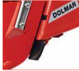
Sıkışmayı önlemek için büyük talaş çıkışı
