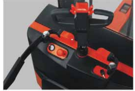
Akü şarj göstergesi, acil stop butonu.
