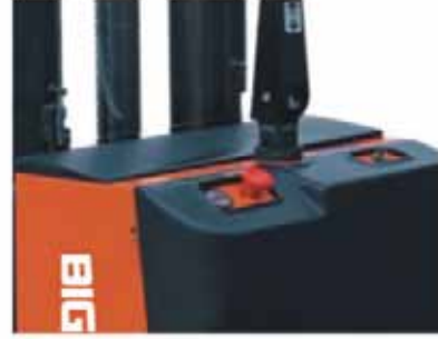
Akü şarj göstergesi ve acil stop butonu.
